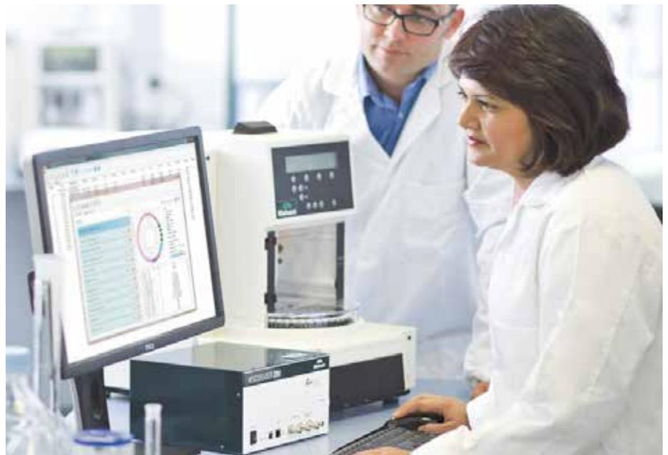
使用毛細管驅動系統的傳統樣品黏度測量一直依賴於檢測從進樣到樣品到達視窗之間經過的流經時間。由於進樣的準確時間很難確定且無法重複，因此會導致重大的黏性測量錯誤。Viscosizer 200 採用了獨特的雙通道玻璃微毛細管，從而避免了潛在錯誤源。
