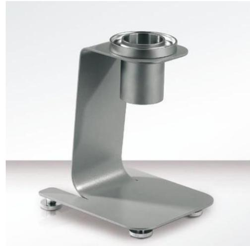
流動杯黏度計是符合 **ISO 2431** 及 **ASTM D-1200** 標準規範設計的 Flow Cup Viscometer。依據標準規範需求，提供 ≥5 centistokes 不同分析範圍所需流動杯。另外，亦整合 Tripod 及 Ergonomic 兩款支架基座，供操作分析選擇。分析原理是於特定溫度下，分析樣品完全通過孔洞 (orifice) 所需時間，得到動黏度 (kinematic viscosity, cSt) 數值。每一個鋁質陽極處理的流動杯於出廠時檢附校正報告，確保流動杯體積及孔洞微細尺寸差異已被校正，保證分析數據準確性。
